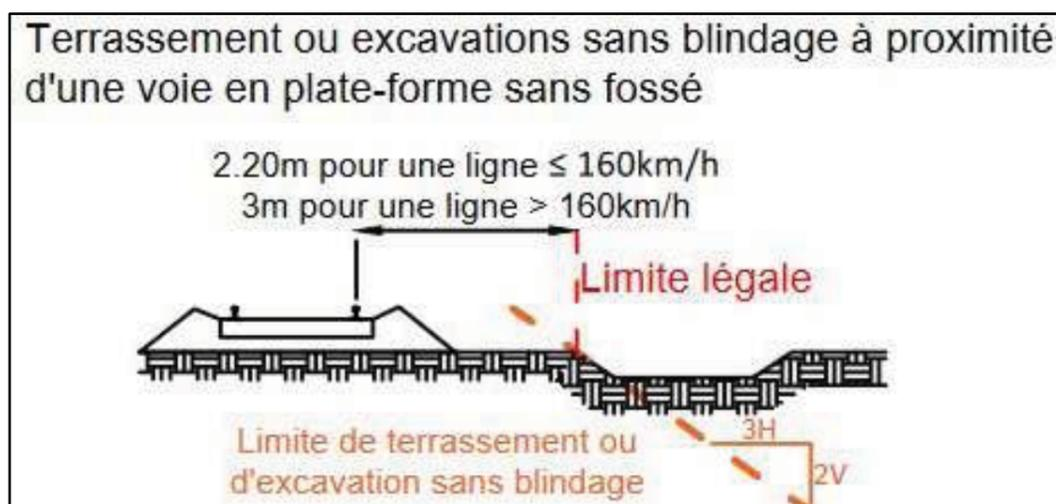
**Exemple 2 : matérialisation de la limite d'excavation, de terrassement et de fondation sans blindage à partir de l'emprise de la voie ferrée pour l'ouvrage d'art aérien.**
