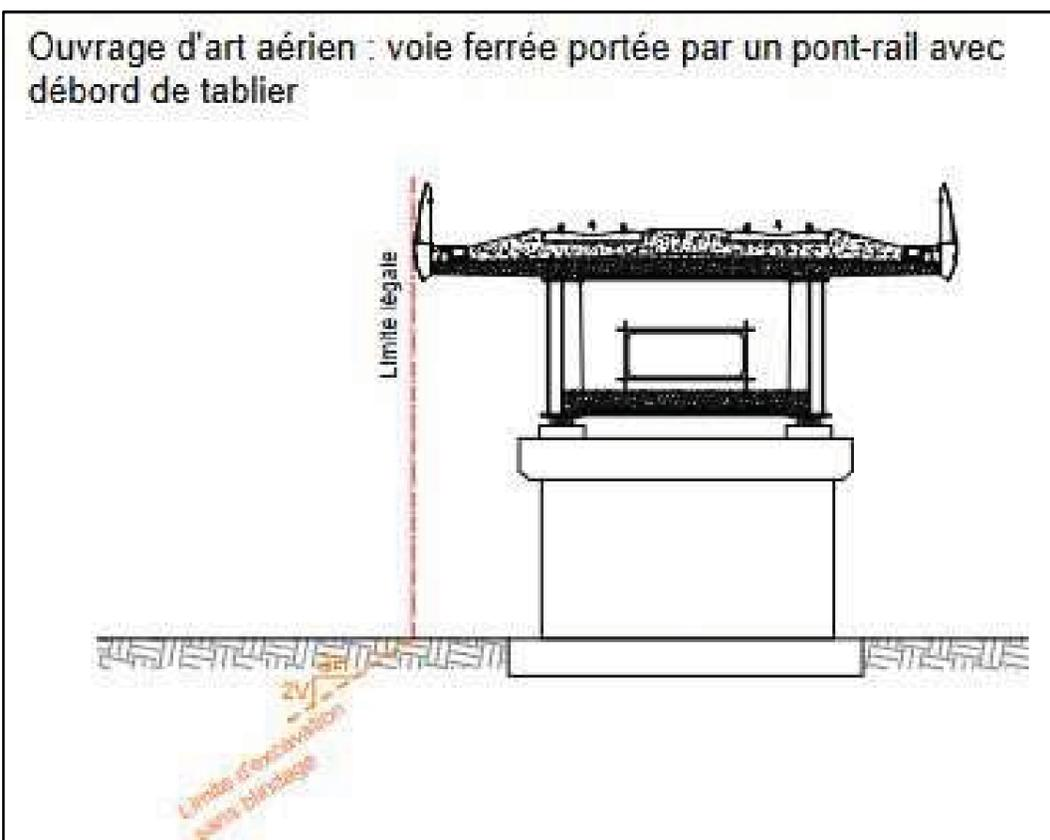
**Exemple 3 : matérialisation de la limite d'excavation, de terrassement et de fondation sans blindage à partir de l'emprise de la voie ferrée pour l'installation radio.**
