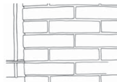
Appareillage d'un mur de clôture en brique rejointoyée à la chaux
