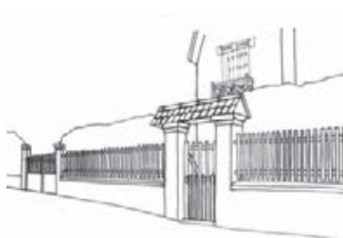
Clôture légère d'une "villégiature" : mur bahut (mur bas qui porte une grille de clôture) en pierre et barreaux de bois peints
