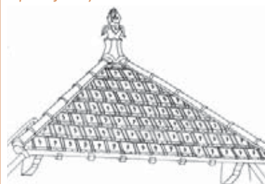
Croupe d'une "villégiature" couverte en tuile mécanique couronnée par un épi de faîtage en terre cuite
