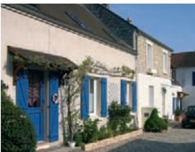
La construction forme un parallépipède rectangle de plain-pied, surmonté d'un toit à deux pans à 35°, ponctué par des souches de cheminée.
