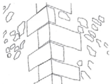
Chaînage d'angle en pierre de taille harpées sur un mur de moellon enduit
