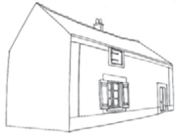
Les linteaux et les appuis des fenêtres sont alignés. Les volets sont en bois plein. Des ouvertures à engranger ventilent les combles
