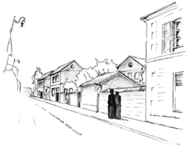
Constructions nouvelles implantées à l'alignement
