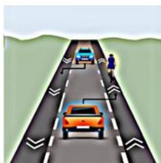
Elle va être aménagée en **Chaussée à Voie Centrale Banalisée** (CVCB, ou « chaucidou »).
