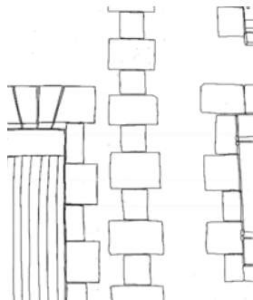
Châinage vertical et encadrements d'ouverture en pierre de taille harpées sur un mur enduit
