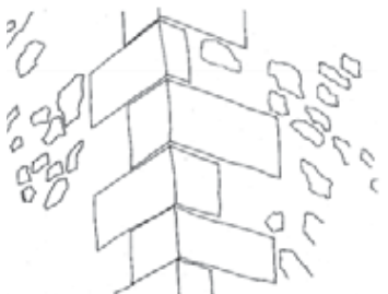
Châinage d'angle en pierre de taille harpées sur un mur de moellon enduit
