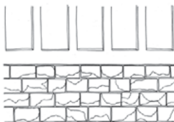
Partie basse d'un mur en moellon calcaire bosselé et partie haute en enduit moulu et faux pans de bois ciment
