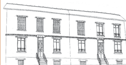
Le logement est accessible par une porte d'entrée vitrée devant un perron. Les linteaux métalliques et les appuis de fenêtre sont alignés, les ouvertures sont fermées par des persiennes métalliques pliantes
