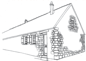
Cette maison jumelle présente une façade en pierre jointoyée au ciment sans enduit couvrant
